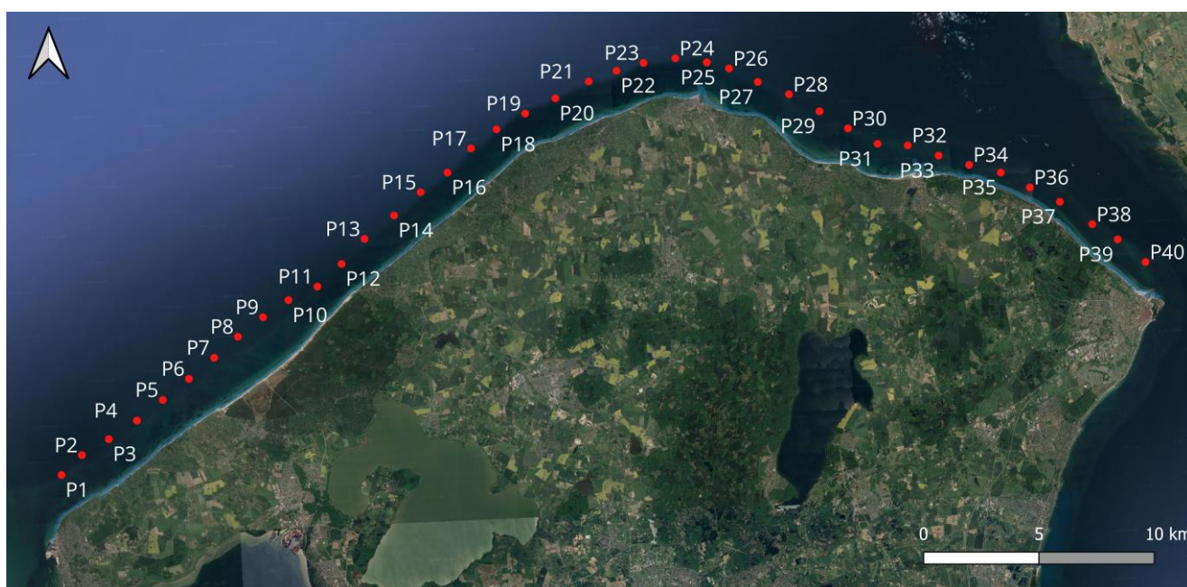
Figur 3.43 Placering af stationspunkter til fastlæggelse af vandstand og bølgeklimate langs Nordkysten fra Hundested (tv.) til Helsingør (th.)
