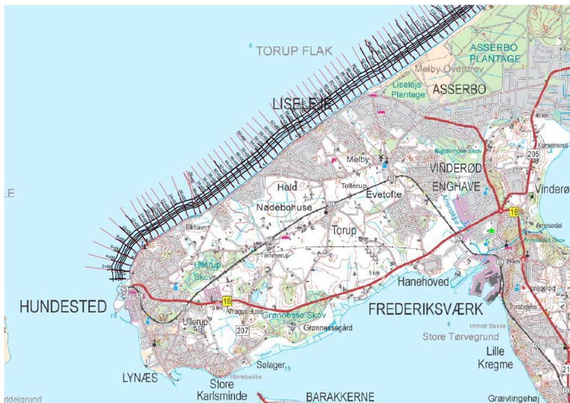
Figur 3.2 Survey-området med opmålte kystprofiler mellem Hundested og Asserbo Plantage. De sorte spor viser de faktisk sejlede linjer. De røde linjer (i vandet) viser de planlagte sejllinjer.
